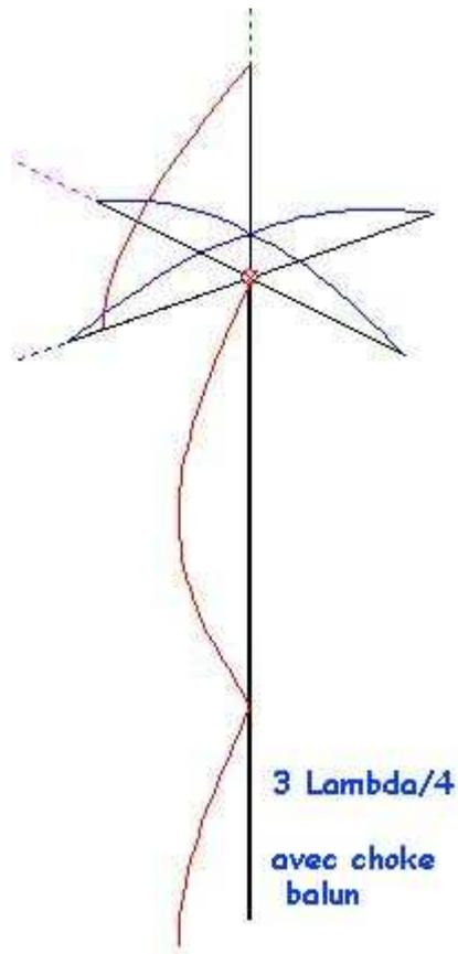
Ci-dessus l'antenne avec une ligne 3 x lambda/4 et un choke balun en haut et ci-dessous la même avec un second choke balun placé lambda/4 plus bas
