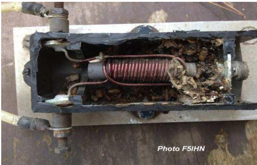
Modèle avec la même référence. Même aspect extérieur mais âme et tresse non réunis en continu. Il s'agit d'un choke balun sur bagues en ferrite plus un condensateur d'une trentaine de picofards réalisé avec un bout de câble coaxial.
