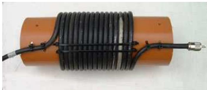
Pour les bandes hautes on peut opter pour 4 spires sur un diamètre de 20 cm ou 5 spires sur un diamètre de 15 cm ou bien encore 8 spires sur un diamètre de 10 cm.
