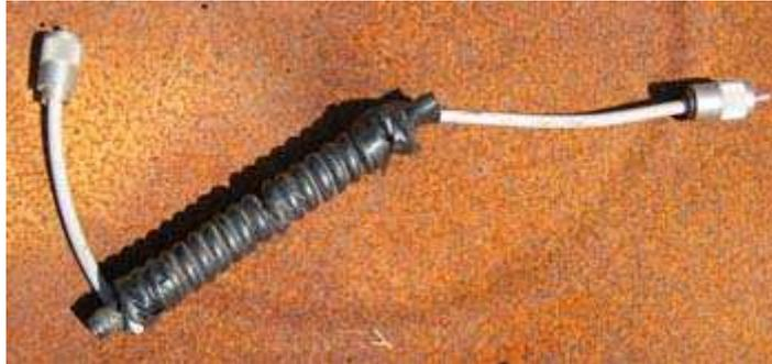
ou à l'intérieur d'un gros tore comme indiqué à droite. On en met le plus possible en deux fois, comme indiqué afin de limiter la capacité parasite entre entrée et sortie
