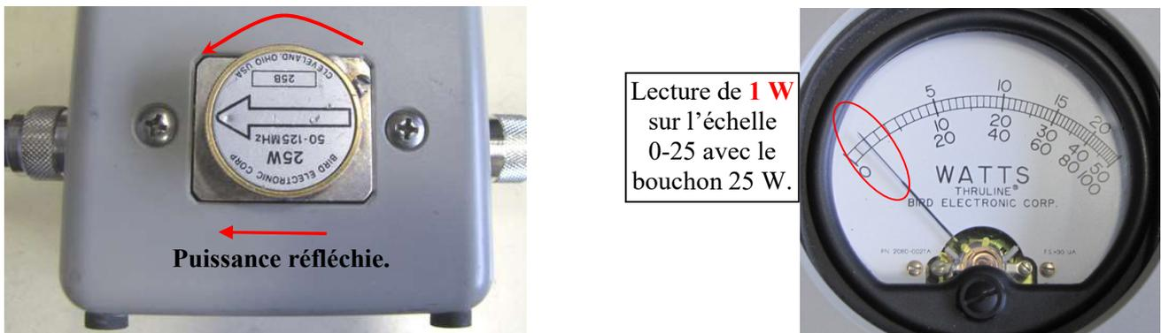
2°) Un bouchon de 1 W peut être mis en place :
